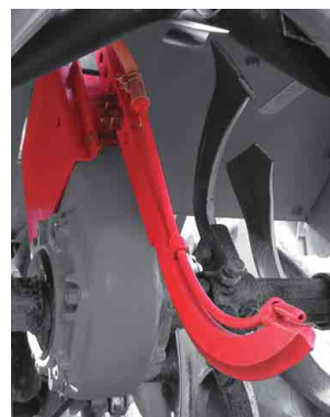
注入ツメ+液ダレ防止バルブ (ノズルはロータリチェーンケースに挟み込み)
