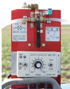
液ダレ防止薬液循環装置+ コントローラ
