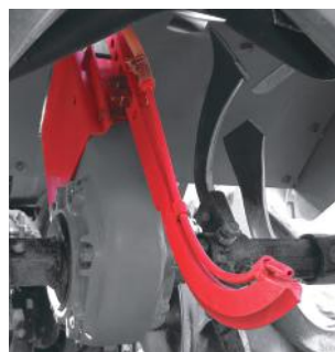
注入ツメ+液ダレ防止バルブ (ノズルはロータリチェーンケースに挟み込み)
